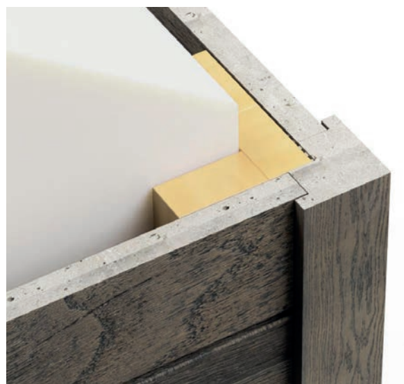
Fig. 8 - Détail de l'angle externe
