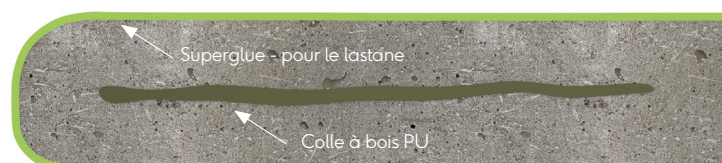
Emplacement de la colle sur les onglets
