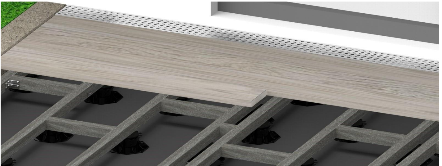
Bild 13. Terrassendielen können auf 2 Unterkonstruktion in der Länge mit offenen Fugen gestoßen werden.
