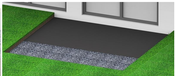
Bild 2. optional kann ein Unkrautvlies verwendet werden.
