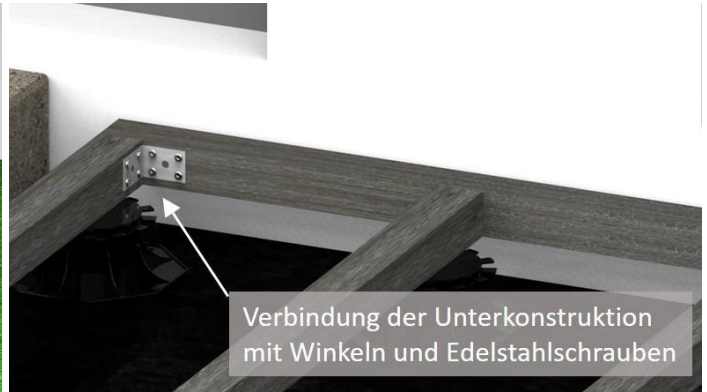
Bild 6 + 7. An den 2 äußeren Unterkonstruktionen werden mit Winkeln die vordere und hintere Unterkonstruktion befestigt.
