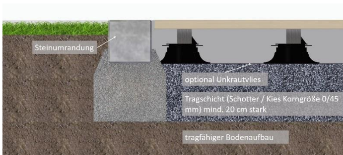
Bild 1. Die Tragschicht sollte ca. 20 cm stark sein.
