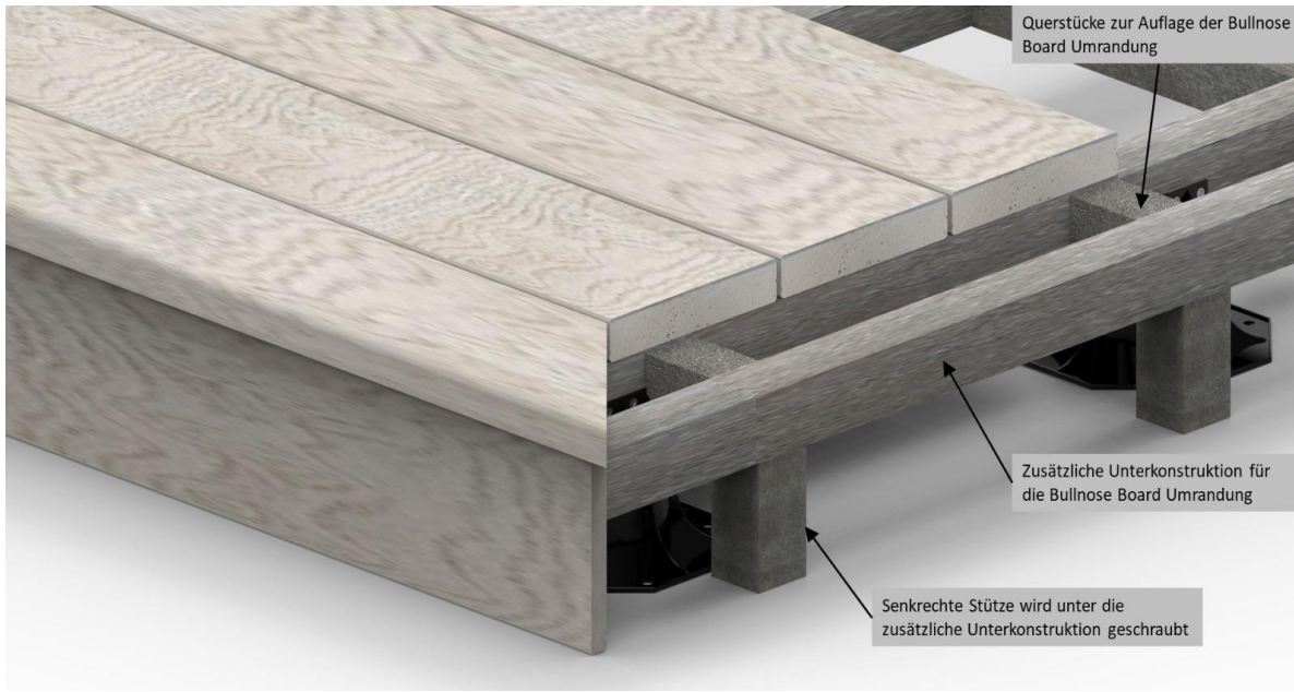
Bild 18. Eine zusätzliche Unterkonstruktion ist für die Auflage der Bullnose Board Umrandung erforderlich. Die Stützen müssen auf die Bauhöhe der Terrasse abgestimmt sein und zusammen mit den Querstücken und der Unterkonstruktion an der Rahmenkonstruktion der Terrasse verschraubt werden.
