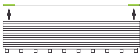
Heben Sie die Paneele an den Kanten mit jeweils 2 Personen an
